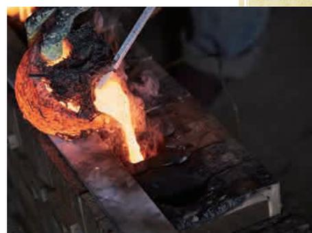
五代晴雲 原惣右工門工房ではほぼ月に一度、鑄造作業を行う。上が蠟型鑄造、下が生型鑄造の様子
