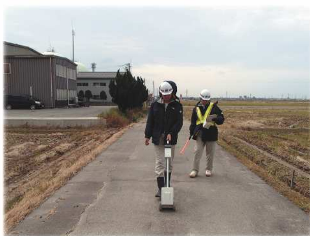
導管漏えい調査
