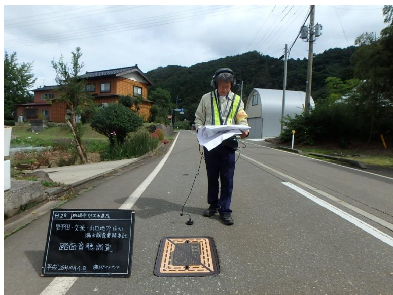
漏水調査（路面音聴調査）
