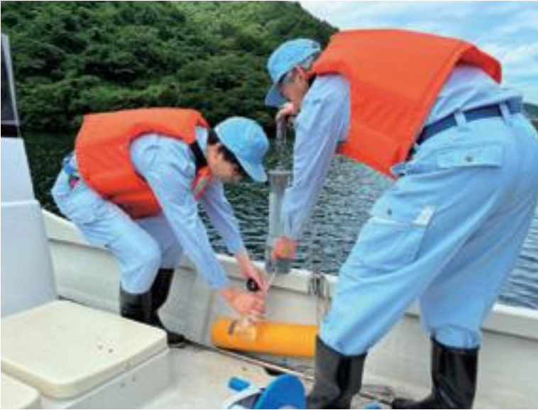
採水器を用いたダム湖水の採水作業です。(浄水場に持ち帰り生物試験、理化学試験を行います。)
