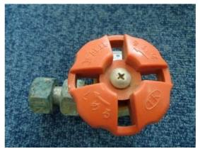
水道管内部の水抜き機能があり、バルブを閉め始めると水抜き穴から水が噴き出ますが、 故障ではありません。全閉にしてしばらくすると水が止まります。必ず、全開か全閉でご 使用ください。
