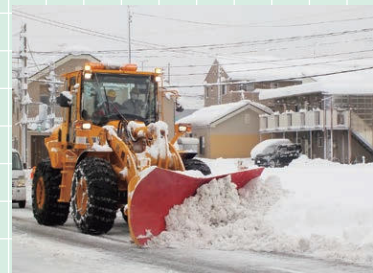
▲ドーザによる除雪作業
