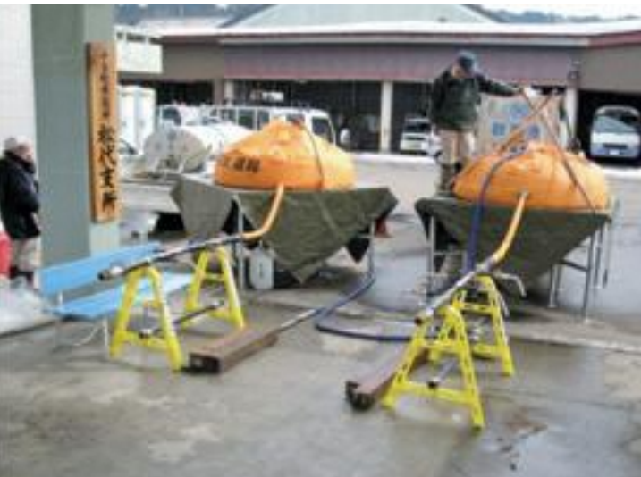
緊急時の給水(キャンバス水槽・仮設給水栓)
