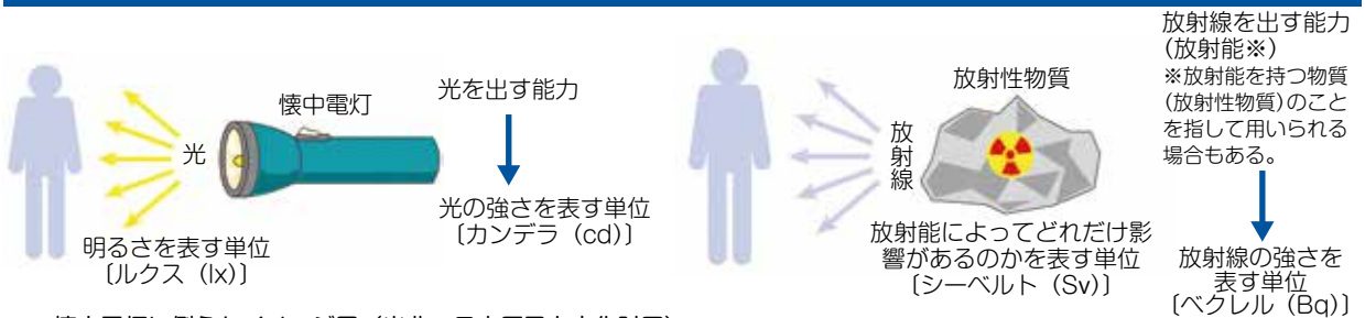
▲懐中電灯に例えたイメージ図 (出典：日本原子力文化財団)
