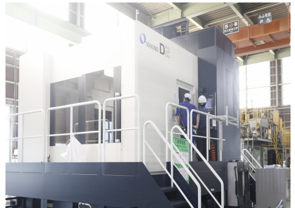
株米谷製作所が導入した大型マシニングセンター
