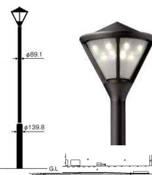
LED公園照明 (38基)
